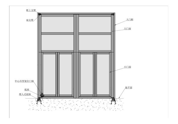
500KG-3T 门轴由底座、门扇下支臂、门扇上支臂及门框上支臂。
